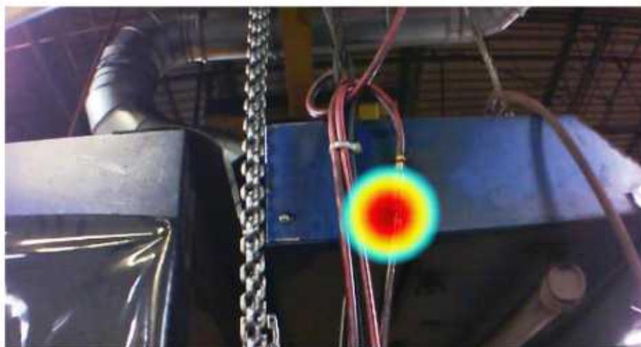
在工業環境中使用 ii900 工業聲波成像儀所拍攝的氣體洩漏影像。
