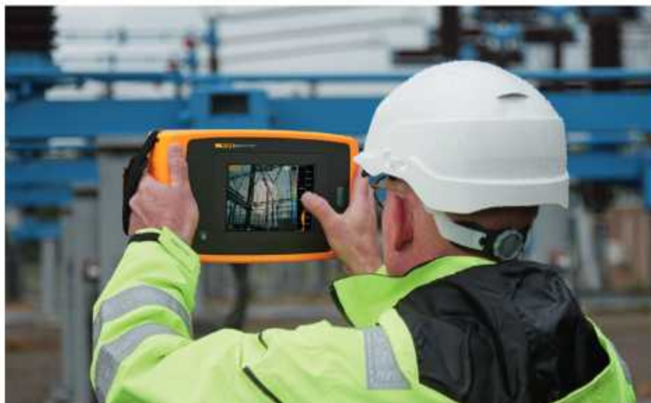
使用 ii910 精密聲波成像儀拍攝影像，可偵測高電壓應用中的局部放電。
