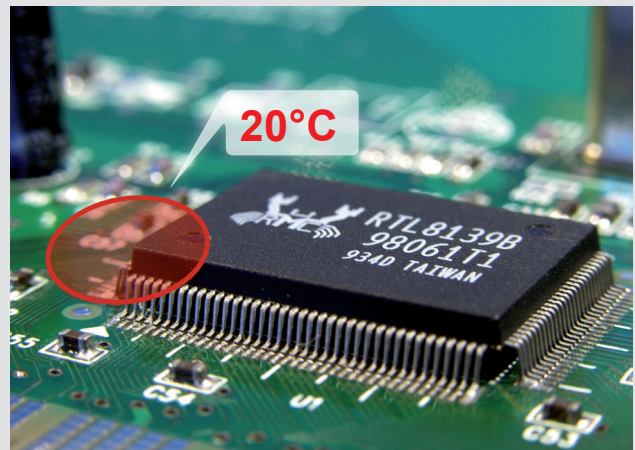
測量點過大導致測量誤差
